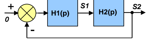
Figure 2 : Schéma bloc de l'oscillateur
