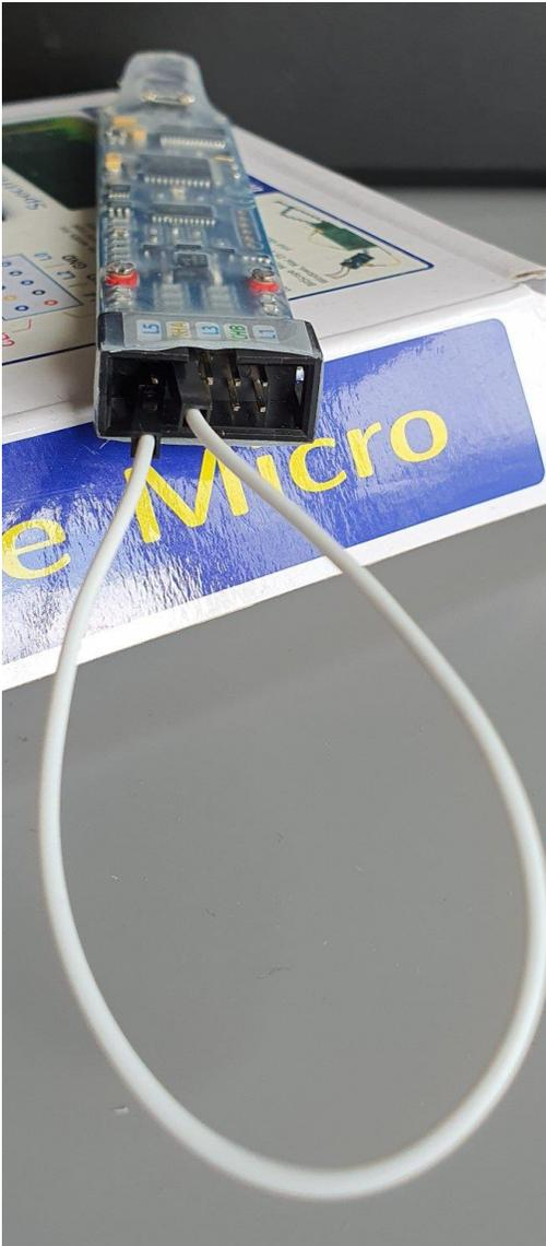
Reliez la sortie du générateur AWG/L4 sur l'entrée de l'oscilloscope CHA en utilisant l'unique cordon femelle / femelle
