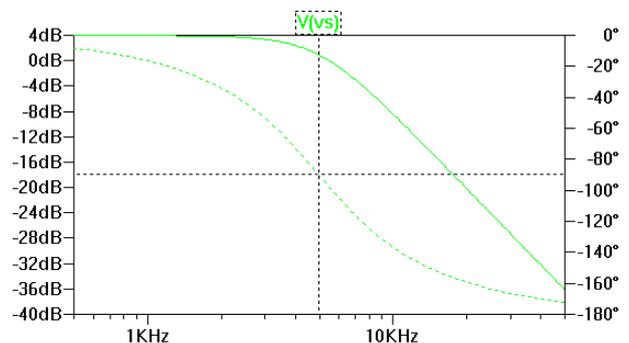
La simulation permet de vérifier que l'on passe bien à  $f_0=5kHz$  à  $-90^\circ$ . Par ailleurs le gain est de 1dB soit 3dB de moins que le gain max du montage qui est donné par la relation  $20 \cdot \log(3-k)$
