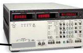
Analyse d'impédance complexe large bande (HP4192A, doc. Technique N4L PSM1735, doc Technique)
