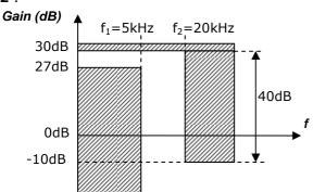
Pour éterminer l'ordre, on utilise les abaques en posant x=20kHz/5kHz=4 et en recherchant le point d'intersection avec -40dB. On trouve un ordre n=3 Dans ces conditions la fonction de transfert est de la forme :
