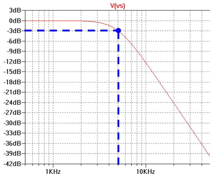
On vérifie bien que pour  $f = f_c = f_0 = 5kHz$ , la courbe de gain passe bien par -3dB.
