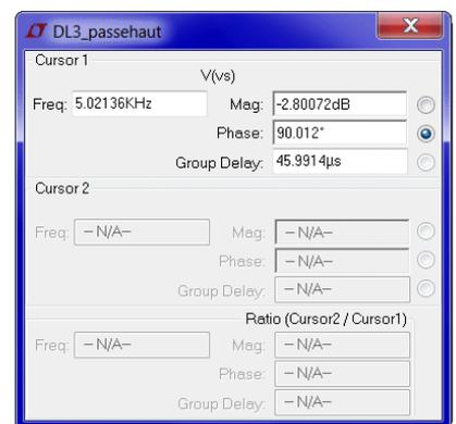
**Q6 :** Comme m est proche de 0,7 on peut considérer que  $f_0$  est quasiment la fréquence de coupure  $f_c$ . Comme le filtre est du 2<sup>nd</sup> ordre on obtient donc une atténuation de 40dB à  $f=500\text{Hz}$  et donc de 80dB à  $f=50\text{Hz}$  ce qui correspond bien aux valeurs de l'énoncé et aux résultats de la simulation précédente.
