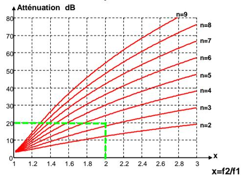
NB : La détermination de l'ordre est possible par calcul dans le cas des filtres de Butterworth
