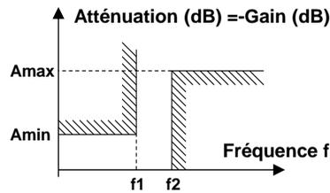
Dans quelques ouvrages ou domaines d'utilisations des filtres on parle aussi de fonction d'atténuation
