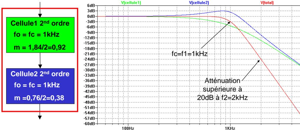
**Butterworth ou l'art d'associer des cellules du 2<sup>nd</sup> ordre avec et sans résonance pour obtenir une réponse fréquentielle la plus plate possible en bande passante.**
