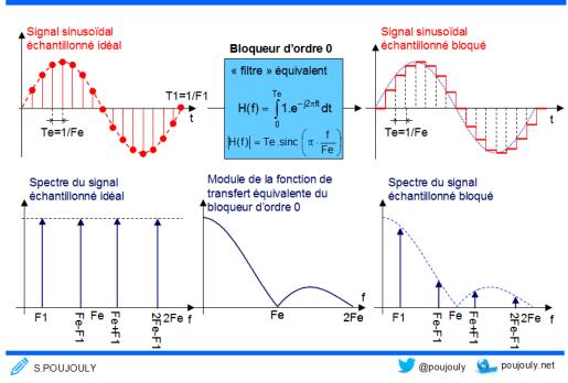
Afin de montrer ce résultat par simulation, il est possible d'effectuer une analyse FFT du signal échantillonné bloqué en prenant un signal résultant de la somme de 4 signaux sinusoïdaux dont les fréquences sont judicieusement choisie par rapport à la fréquence d'échantillonnage comme l'indique le schéma suivant.
