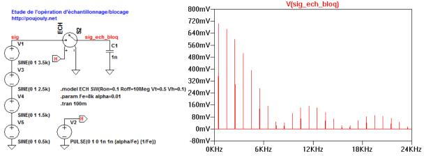
**Q7:** Télécharger le fichier **echant\_blocage\_4signaux.asc** et effectuer l'analyse FFT afin d'obtenir la représentation ci-dessus qui montre clairement l'effet de filtrage équivalent du bloqueur d'ordre 0 sur les différentes composantes fréquentielles :
