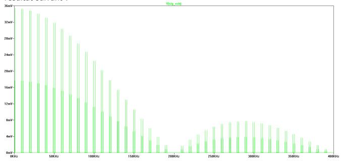
Q4: Pour quelle raison les amplitudes des raies s'annulent à 200kHz et 400kHz? Retrouve-t-on la fréquence 1kHz du signal sinusoïdal dans le signal échantillonné réel? Quelles sont les autres composantes que l'on retrouve également ?
