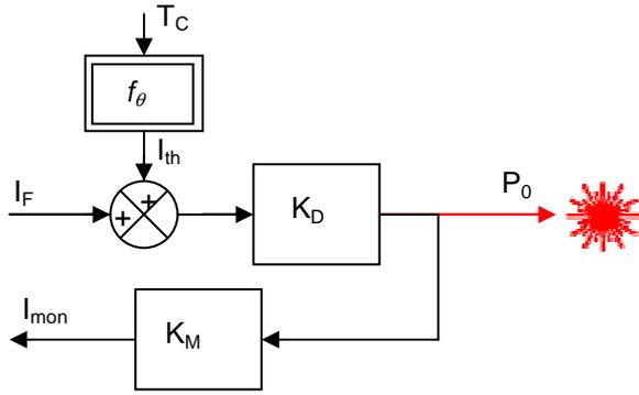
Figure 1 : Modèle de la diode
