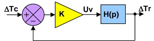
**Q2** : Calculer la fonction de transfert en boucle fermée  $FTBF(p) = \frac{\Delta Tr(p)}{\Delta Tc(p)}$  du système asservi et montrer qu'elle peut se mettre sous la forme d'une fonction de transfert passe bas du 2nd ordre dont vous préciserez l'expression du coefficient d'amortissement  $m_1$ , de la pulsation propre  $\omega_{01}$  et de l'amplification statique  $\alpha$ .
