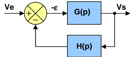
**Q1 :** Montrer que le montage peut se mettre sous la forme du schéma bloc proposé. Exprimer les fonctions de transfert H(p) et G(p) en fonction des éléments du montage Ra, Rb et des paramètres caractéristiques de l'ampli-op Ao & ωo.
