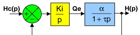
**Q4** : Calculer la fonction de transfert en boucle fermée  $FTBF(p) = \frac{H(p)}{H_c(p)}$  du système asservi et montrer qu'elle peut se mettre sous la forme d'une fonction de transfert passe bas du 2nd ordre dont vous préciserez l'expression du coefficient d'amortissement  $m$ , de la pulsation propre  $\omega_0$ . Déterminer la valeur de  $K_i$  afin d'obtenir une réponse indicielle sans dépassement.
