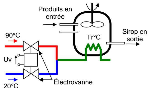
Afin de mettre en place l'asservissement on effectue un essai en boucle ouverte du système dans lequel on note la variation de température du réacteur  $\Delta Tr$  par rapport à la commande en tension des 2 électrovannes. On obtient le relevé proposé sur la figure se trouvant sur le document réponse lorsque la tension de commande  $U_v$  passe de 0 à 1V.
