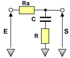
**Q1 :** Exprimer la fonction de transfert de ce montage et montrer qu'elle peut se mettre sous la forme  $T(p) = \frac{S(p)}{E(p)} = \frac{1 + \tau p}{1 + \tau_a p}$ . Exprimer les constantes de temps  $\tau$  et  $\tau_a$  en fonction des éléments du montage.
