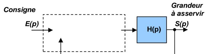
**Q1 :** Ce processus est inséré dans un système asservi composé d'un retour unitaire et d'un correcteur proportionnel dont le gain (linéaire) est  $K$ . Représenter le schéma bloc de ce système asservi en complétant le schéma de la figure proposée. Indiquer où se trouve le signal erreur  $\varepsilon(p)$
