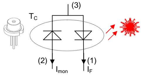
Figure 2 : schéma électrique
