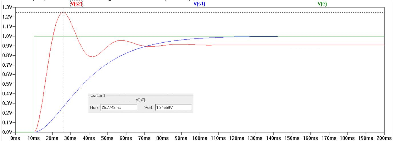
**Q1 :** Justifier simplement en observant la sortie S1 que le modèle  $H(p)$  est un modèle de type passe bas mais dont l'ordre est supérieur à 1.
