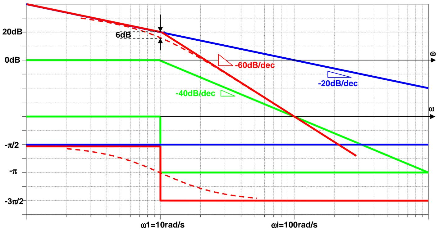
**Q3 :** L'argument de  $T_{BO}$  passe par  $-\pi$  pour  $\omega_1 = \frac{1}{\tau_1} = 10\text{rad/s}$ .
