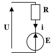
On note  $E$  la force contre électromotrice due au déplacement de la bobine. On considère que  $E = \alpha \frac{dx}{dt}$  avec  $\alpha=10$  (SI) et  $x$  représente la position de la bobine.
