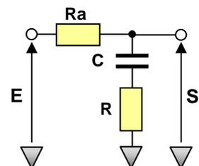
**Q1 :** Montrer que les 2 montages proposés réalise le même type de fonction de transfert. Exprimer les variables a et  $\tau$  en fonction des éléments pour chacun des montages. Quelle est la différence entre ces 2 structures ?
