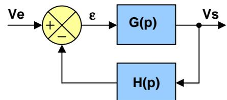
**Q1 :** Montrer que le montage amplificateur non inverseur peut se mettre sous la forme du schéma bloc proposé. Exprimer les fonctions de transfert  $H(p)$  et  $G(p)$  en fonction des éléments du montage  $R_1$ ,  $R_2$  et des paramètres caractéristiques de l'ampli-op  $A_o$  &  $\omega_0$ .
