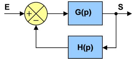
**Q4 :** Calculer la fonction de transfert en boucle fermée et la mettre sous la forme canonique suivante :  $FTBF(p) = K \cdot \frac{1}{1 + \frac{p}{\omega_c}}$
