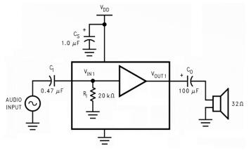
**Q3**: En fonctionnement normal, la sortie de l'amplificateur délivre le signal  $V_{OUT1}(t)=V_{DD}/2 + U1.\sin(2\pi.f1.t)$  avec  $V_{DD}=3V$ , U1=1V et f1=500Hz. Tracer le spectre de ce signal et indiquer l'influence du filtre sur les composantes fréquentielles. Représenter alors le signal obtenu aux bornes du casque audio.
