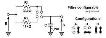
**Q2**: Exprimer les 3 fréquences de coupure pour les 3 configurations proposées en fonction des composants R1, R2 et C. Effectuer les applications numériques correspondantes.
