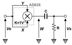
Q2 : Quelle est la nature du filtre présent entre la sortie du multiplieur et la sortie Vs du montage. Calculer sa fréquence de coupure.
