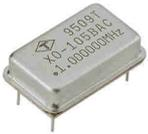
**Q12 :** On considère un oscillateur à quartz délivrant un signal d'horloge compatible TTL (0-5V) de fréquence 1MHz. Tracer le spectre en amplitude du signal d'horloge et en déduire la représentation fréquentielle que l'on obtiendrait sur un analyseur de spectre FFT dont la configuration est donnée ci-contre
