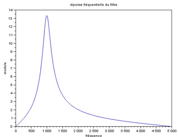
**Q3 :** Il s'agit d'un filtre passe bande dont la fréquence centrale est de 1kHz (lorsque le module est maximum).
