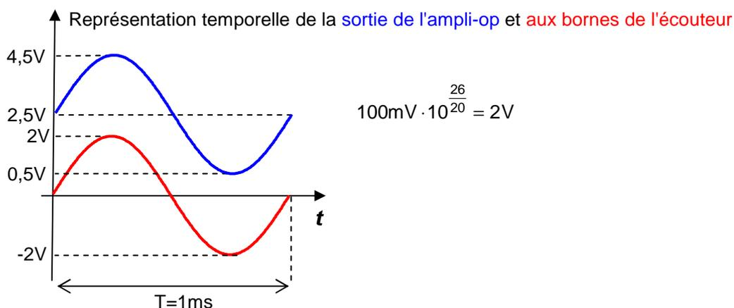
La puissance obtenue aux bornes de l'écouteur est  $P = \frac{U_{\text{eff}}^2}{32\Omega} = \frac{\hat{U}^2}{2 \cdot 32\Omega} = 62,5\text{mW}$
