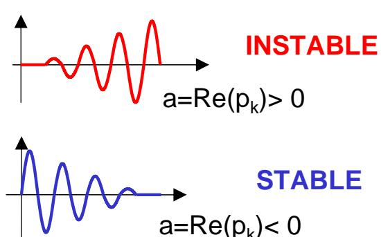
Un système linéaire bouclé est stable si et seulement si tous les pôles de sa fonction de transfert en boucle fermée (FTBF) sont à partie réelle strictement négative.
