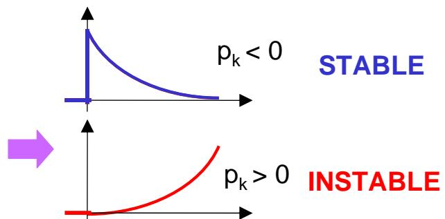
$$\frac{A_k}{p - p_k} \rightarrow A_k e^{at} \cos(\omega t + \varphi) \quad \text{Si le pole } p_k \text{ est complexe}$$
