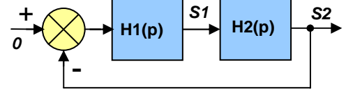
Figure 2 : Schéma bloc de l'oscillateur
